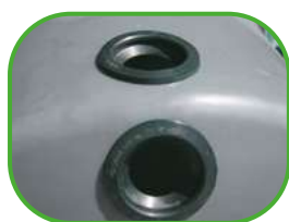
Pose joints à lèvres
