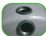
Pose joints à lèvres
