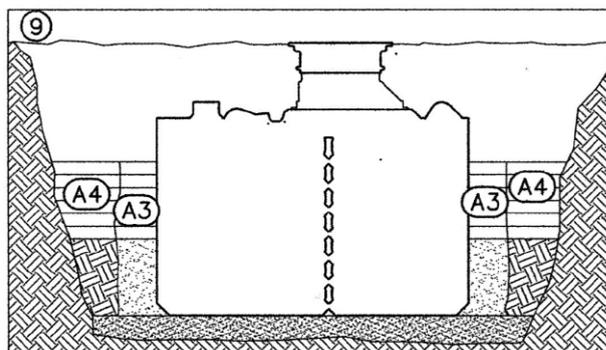
Les canalisations et la rehausse pour l'élimination des boues sont mis en place.
