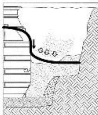
La précontrainte requise du treillis doit être générée pendant le processus de remblayage.
