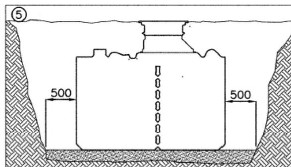
En raison du transport, le cône est généralement déjà fixé sur la cuve au moyen de vis.
