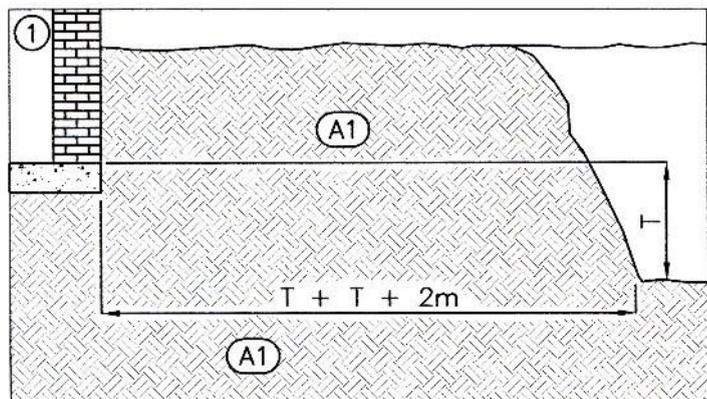
Une distance minimale jusqu'aux bâtiments doit être observée si la couche en béton est plus profonde que la fondation, voir le NF DTU 64.1
