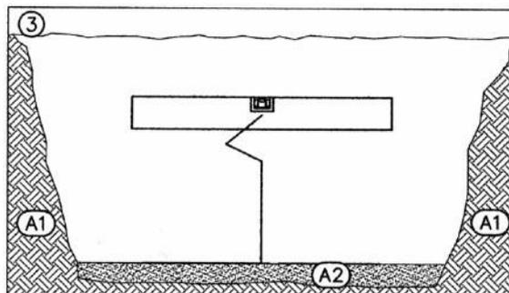
La cuve doit être soulevée avec des sangles et mise en place avec précaution dans la fouille.
