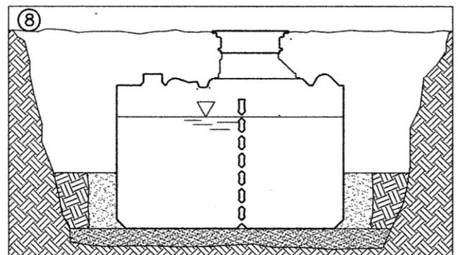
La zone jusqu'en dessous du bord inférieur des raccordements de la cuve est remplie et compactée, tel que décrit dans l'illustration 7.
