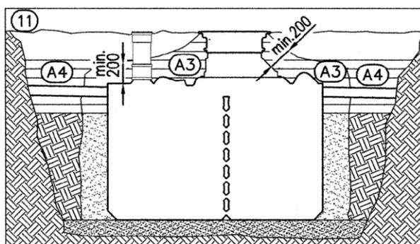
Notes importantes pour la version 10 EH, en 2 cuves : lors de l'installation des deux cuves, il faut s'assurer les cuves sont positionnées à la même hauteur.
