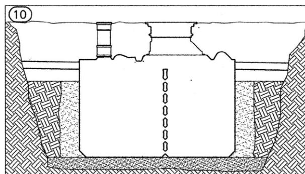
La zone dans la partie supérieure de la cuve est remplie et compactée, tel que décrit dans l'illustration 7.
