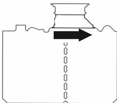
**Le montage ne doit être exécuté que si le sol dans la fouille est sec ou légèrement humide ; en cas de présence d'eau dans la fouille, un abaissement des eaux souterraines doit être effectué.**
