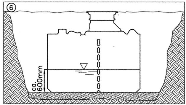
Remplissage et compactage a u t o u r de la cuve avec le matériel de remplissage A3 (selon le chapitre 2.1) d'une largeur minimum de 300 mm, puis plus loin avec d'autres matières, comme par ex. déblais A4 (selon le chapitre 2.2) jusqu'au niveau du premier remplissage d'eau.
