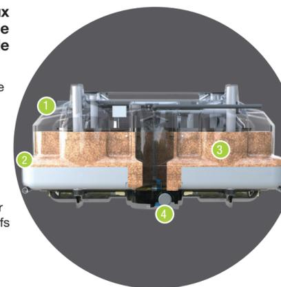
3 Le milieu filtrant Composé de coco 100 % recyclable de qualité contrôlée, ce filtre assure le traitement biologique, la filtration et la rétention des polluants jusqu'à leur dégradation. Il constitue une véritable barrière physique qui, tout en protégeant le sol en place, assure une longévité de la zone d'infiltration.
