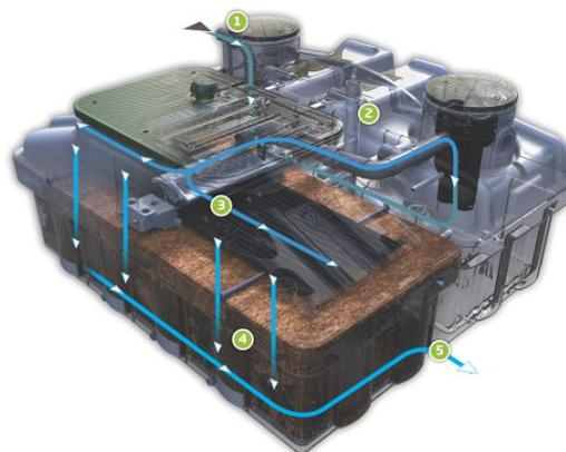
Le(s) tube(s) PVC, constitutif(s) de la structure interne de l'enveloppe principale, permettent la circulation de l'air entre la surface et la base du milieu filtrant. La circulation de l'air dans l'ensemble du système est assurée par convection, à partir de la ventilation primaire de l'habitation (ou d'un événement indépendant) via la conduite d'alimentation et la fosse septique.
